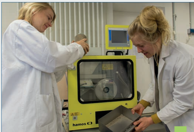
Sonja Oberbeckmann und Kristina Enders separieren Plastikpartikel aus Strandsand mit Hilfe eines elektrostatischen Separators von hamos (Korona Walzen Schneider). / Sonja Oberbeckmann and Kristina Enders separate plastic particles from beach sand using an electrostatic separator from hamos (Korona Walzen Schneider). (Foto / Source: S. Kube, IOW)
