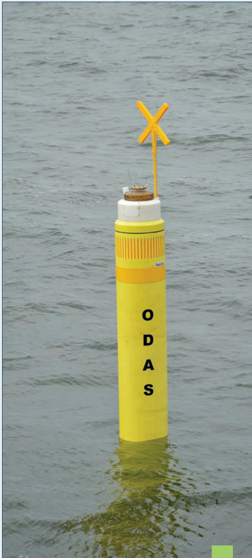
Die neue MARNET Spierenboje in der Oderbucht. / The new MARNET spar buoy (Foto / Source: E. Stohr, IOW)
